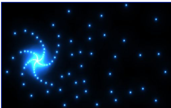
La configurazione "a galassia" di SKA. Ogni punto conterrà centinaia di antenne sensibili a varie lunghezze d'onda. L'intero sistema avrà un'ampiezza di oltre 3000 km.
